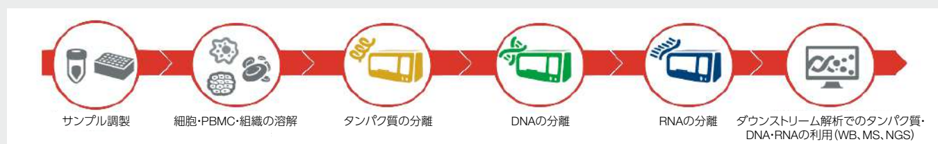
図6. 単一サンプルからタンパク質、DNA、RNAを自動的に分離するワークフロー。
